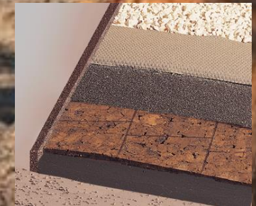
Isolamento de telhados planos
