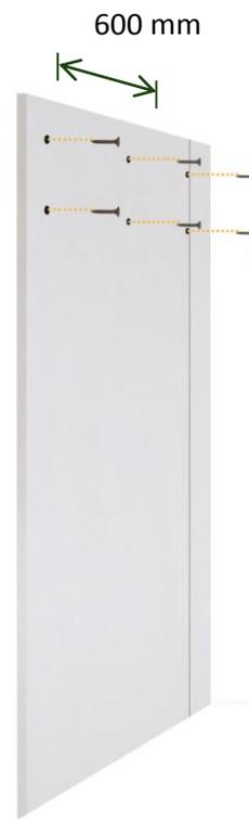
Fixação da placa de gesso laminado Gyptec ao sistema Lambourdé com recurso a parafusos PM aplicados em pontos coincidentes com as tiras de madeira para melhor suporte.
