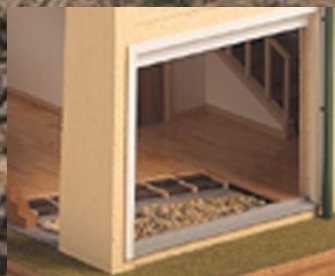
Isolamento térmico por baixo de soalhos
