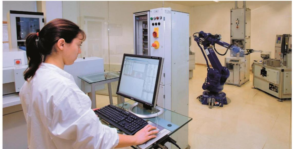
A **SECIL ARGAMASSAS** dispõe de um Laboratório de Controlo de Qualidade, cuja a função é avaliar a conformidade dos produtos que fabrica com os requisitos das respectivas normas e efectuar outros ensaios químicos e físicos de caracterização complementar de produtos e de suporte à I&D.
