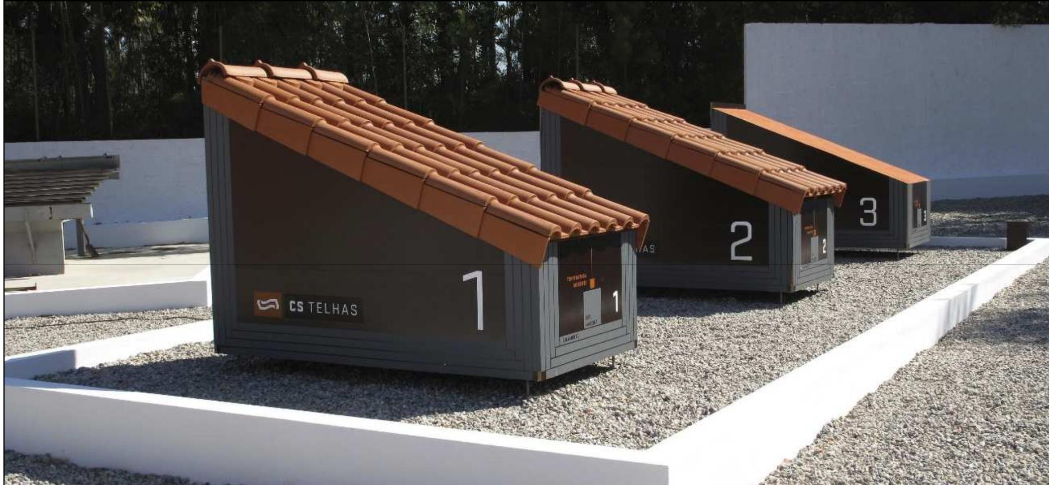
Construímos 3 células de teste iguais, aferimos o sistema, executámos 3 soluções de cobertura e comparámos os resultados.
