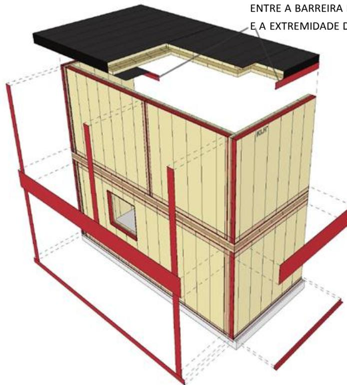
SOBREPOSIÇÃO DA SELAGEM ENTRE A BARREIRA PARA VAPOR E A EXTREMIDADE DA PAREDE
