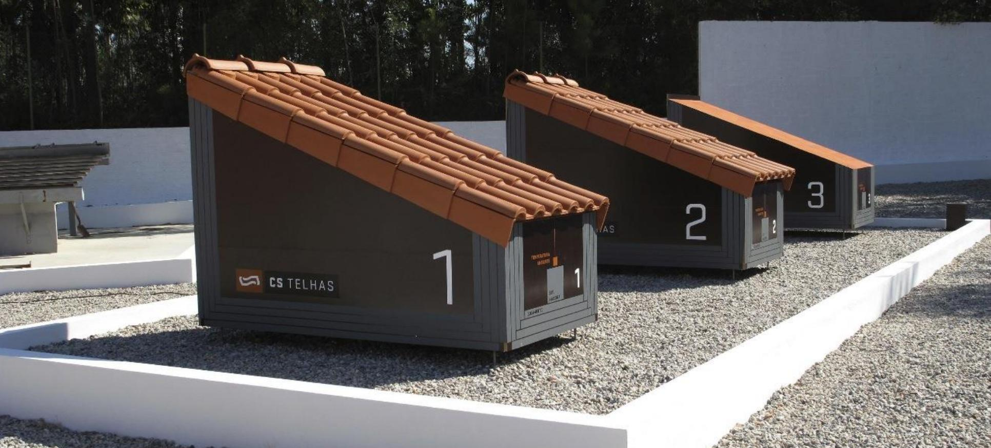
Construímos 3 células de teste iguais, aferimos o sistema, executámos 3 soluções de cobertura e comparámos os resultados.
