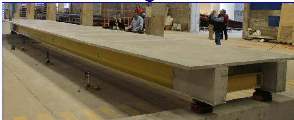
Painéis sandwich compósitos para a reabilitação de pisos de edifícios
