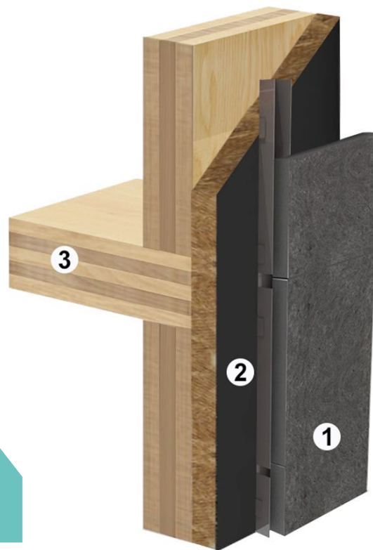
FIGURA 35 • Solução com estrutura de CLT com fachada ventilada
