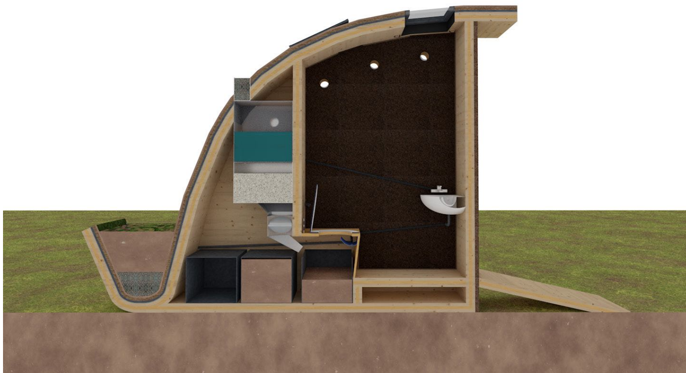
FIGURA 61 ● Protótipo de casa de banho de compostagem (Fonte: Portal de Arquitetura e Construção Sustentável)
