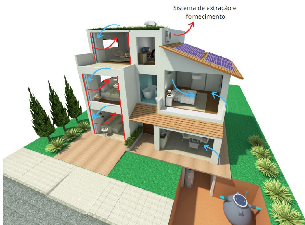
FIGURA 48 • Ventilação com recuperador de calor
