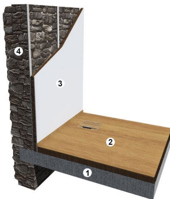
FIGURA 23 ● Isolamento aplicado pelo interior
