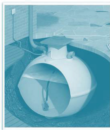
Fig. Exemplo de cisterna de armazenamento de água das chuvas
