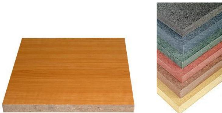
Fig.3.9 – Painéis de MDF com acabamento em madeira e coloridos [30]
