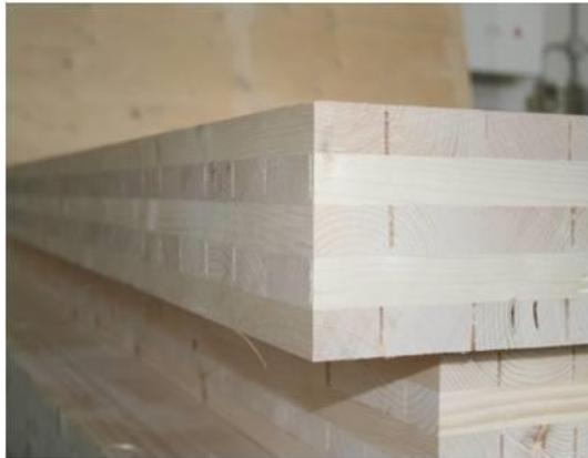
Fig.4.8 – Lamelas em grelha, X-LAM [22]
