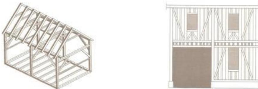
Fig.2.9 – Sistema Porticado, à esquerda, e Sistema Entramado, à direita [2]
