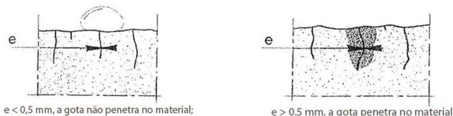
Fig.5.29 – Penetração da água nas paredes por acção da gravidade [3]
