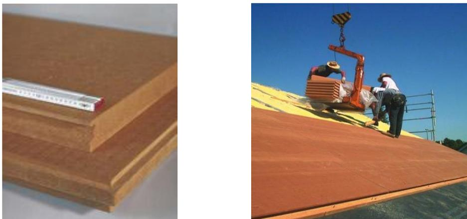
Fig.4.1 – Painel de AGEPAN e exemplo de aplicação [43]
