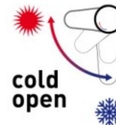
**poupança de água e de energia** a abertura frontal em água fria, evita o arranque desnecessário do esquentador ou o gasto de água quente do Termoacumulador.
